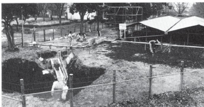
浸透トレンチへの流入/流出量と トレンチ周辺の土壌水分挙動の観測
